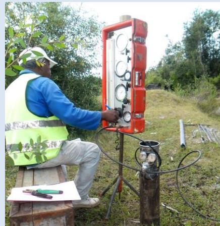
Site d'implantation de la station de traitement / Mesure pressiométrique
